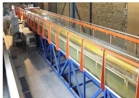
Fig. 1 General view of flume with inclined floodplains شکل ۱ نمای کلی آبراهه آزمایشگاهی با سیلابدشت‌های مایل
